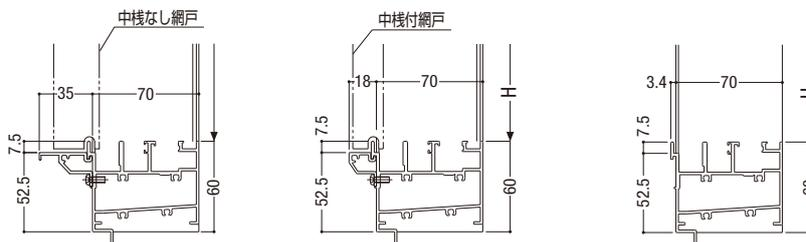
下枠外部アタッチ (35mm) を取付ける場合
