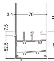
下枠外部アタッチ (35mm) を取付ける場合
