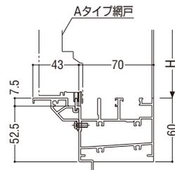
下枠外部アタッチ (43mm) を取付ける場合
