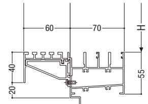
下枠外部アタッチ (43mm) を取付ける場合
