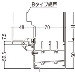
下枠外部アタッチ (48mm) を取付ける場合
