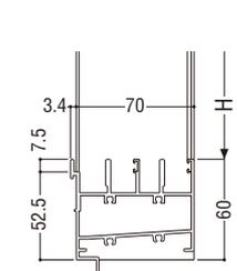
下枠外部アタッチ (43mm) を取付ける場合
