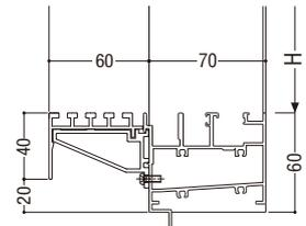
下枠外部アタッチ (4.3mm) を取付ける場合
