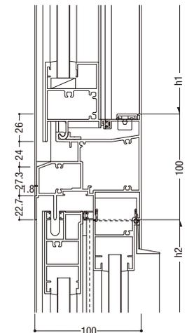
18 インベイ外倒し排煙 / 外動片引き
