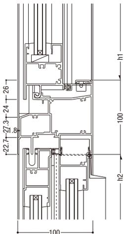
19 インベイ外倒し排煙 / 外動片引き
