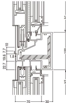
19 外倒し排煙 (インベイと共通) / 両袖可動・中央可動・中央引き分け
