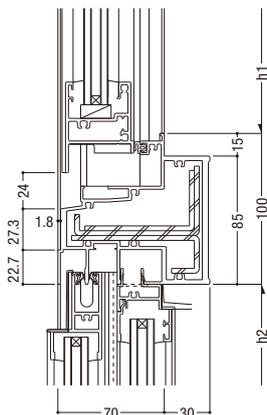
22 インベイ内倒し排煙 / 両袖可動・中央可動・中央引き分け
